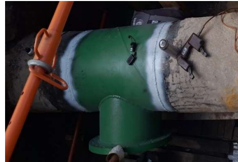
Figura 31 – Inspeccionadas as soldaduras método ultrassom
